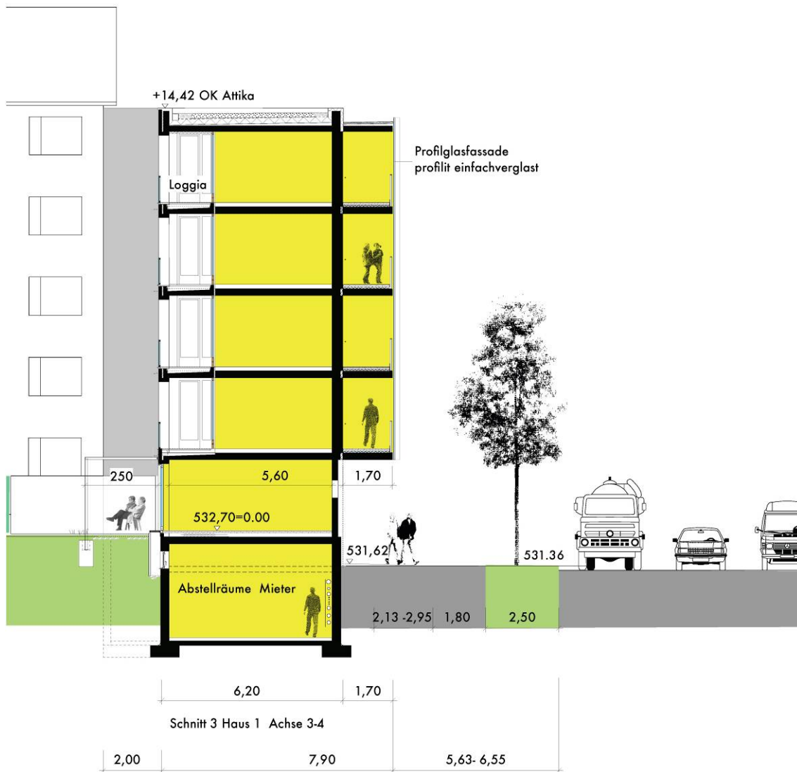
Abb. 80: Gebäudeschnitt Verbindungsbau (Krieger Architekten)
