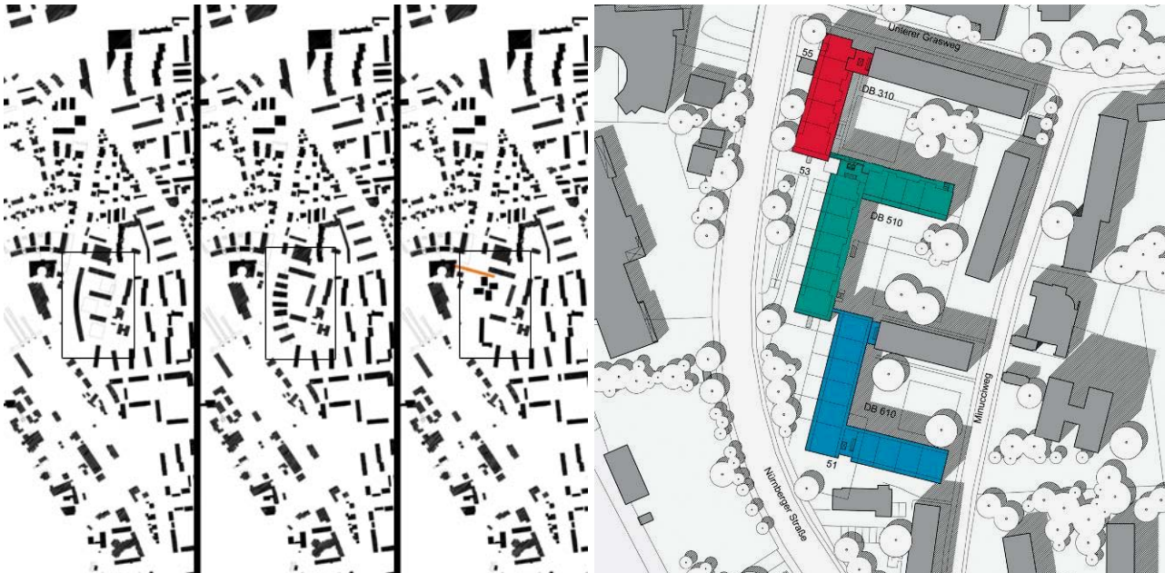
Abb. 65: links – städtebauliche Varianten zur Optimierung von Lärmschutzmaßnahmen (Varianten: „Schwinge“, „Kamm“, „Maschine“) / rechts – Konzept der neuen städtebaulichen Struktur (Dokumentation Deutscher Bauherrenpreis 2010)
