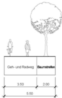
Beispielquerschnitt Nebenroute mit getrenntem Geh- und Radweg
