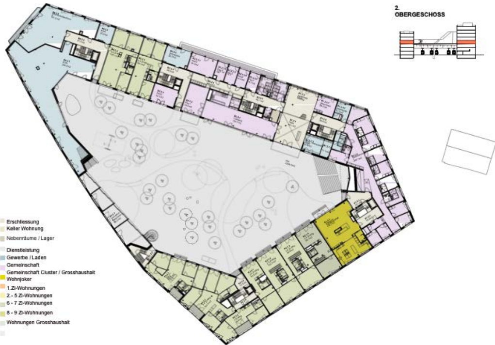
Grundriss 2. Obergeschoss mit Innenhof
