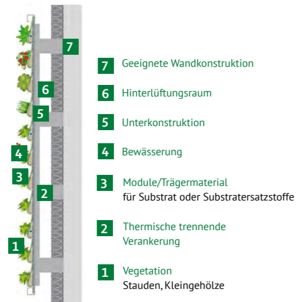
Schematische Darstellung einer wandgebundenen Fassadenbegrünung. Quelle: BuGG
