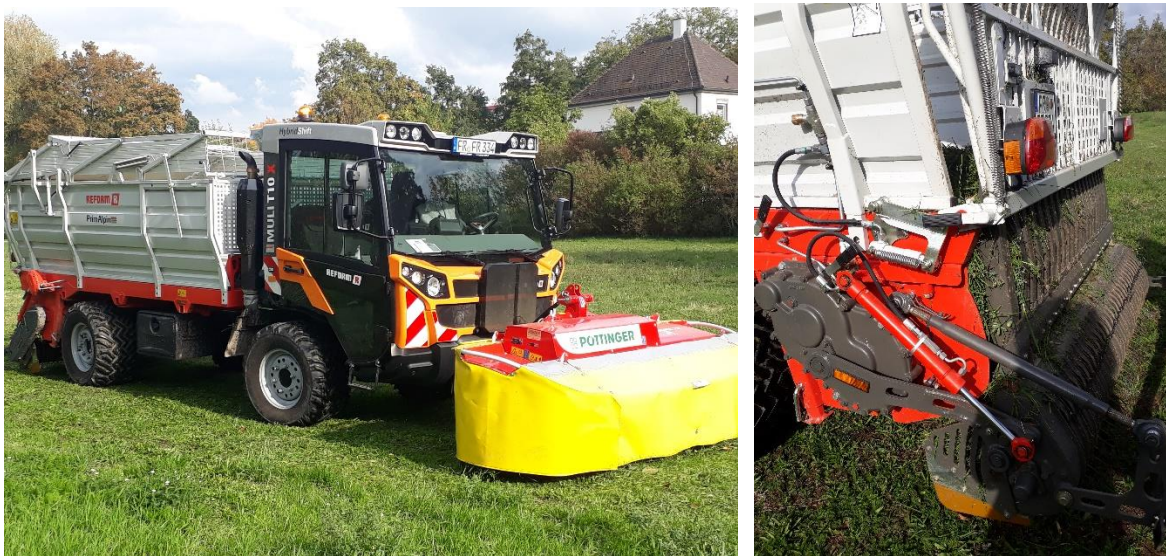
Reform Multi T 10 mit Kreiselmähwerk und Ladecontainer, im Juli 2020 beim GuT neu angeschafftes Gerät zur Wiesenmahd incl. Aufnahme des Mähguts (Fotos: U. Hammes).
