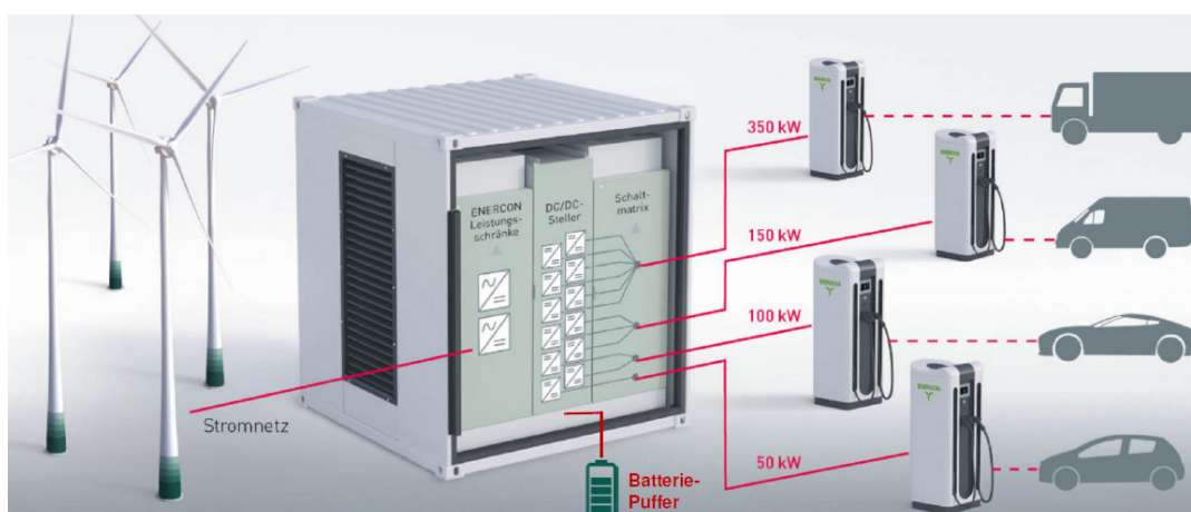
Abbildung 30 – Schematische Darstellung des modulierbaren Schnellladesystems (DARSTELLUNG ENERCON 2018)
