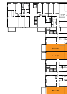
Regelgeschoss Winkelbau: Durchwohngrundrisse
