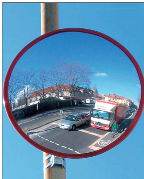
Sichthilfe: Der Trixi-Spiegel ermöglicht aus dem Lkw Einblicke in den toten Winkel und kann so schwerste Unfälle verhindern. (Foto: TU Kaiserslautern)
