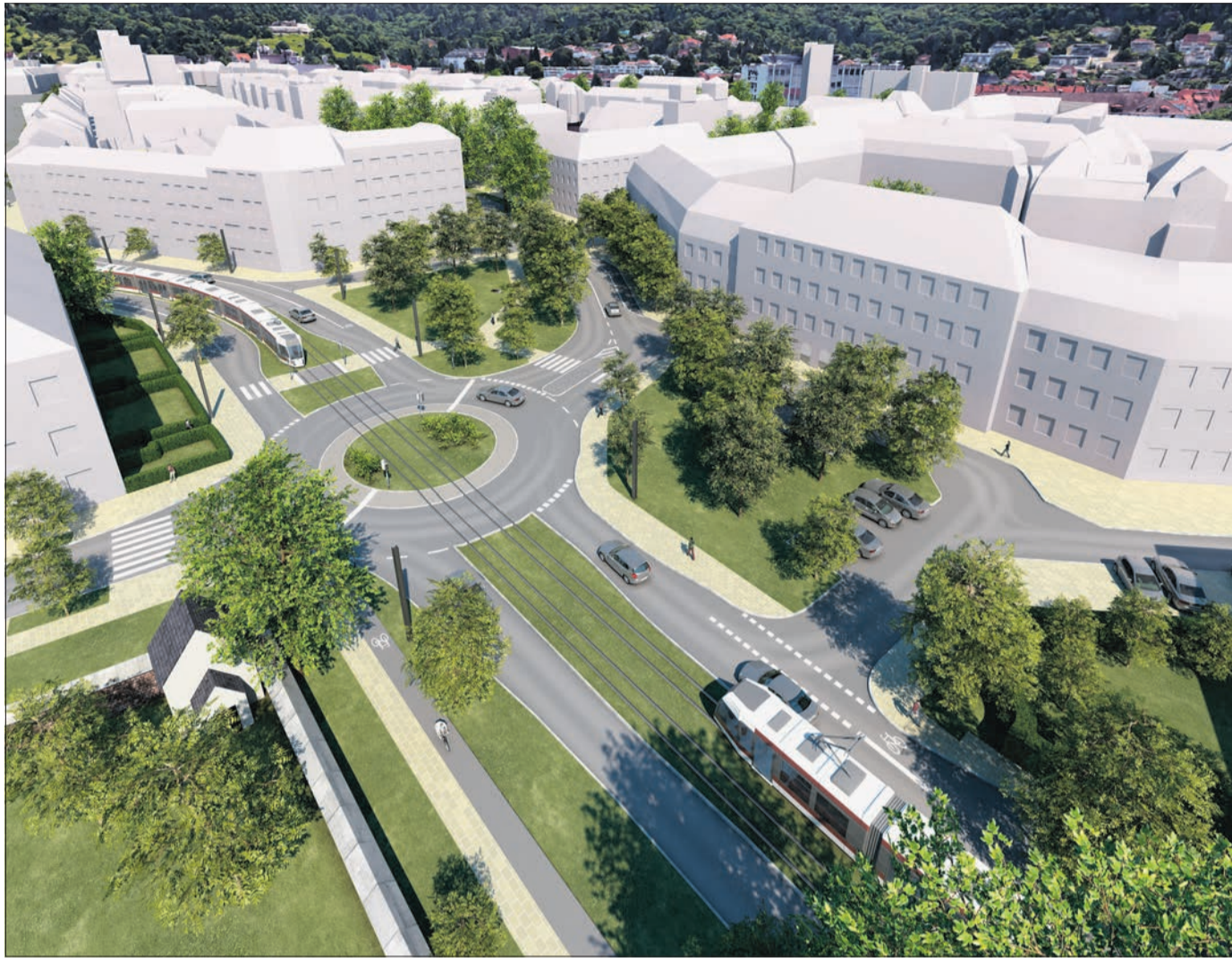
Hier geht's rund: Die Kaiserstuhlstraße (links) wird per Kreisverkehr an die Waldkircher Straße angeschlossen. Den durchquert – ein Novum in Freiburg – die neue Stadtbahntrasse. Die Grünfläche an der ehemaligen Haltestelle Rennweg wird vergrößert und besser zugänglich gemacht. (Visualisierung: LINK 3D Freiburg)
