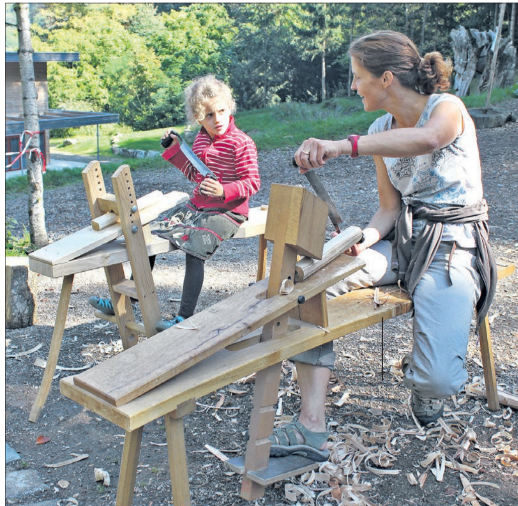
Dieser Esel macht nicht iah! In der Holzwerkstatt des Waldhauses lernen Besucherinnen und Besucher auf dem Schneidesel auf traditionelle Weise Holz zu bearbeiten. (Foto: Waldhaus)
