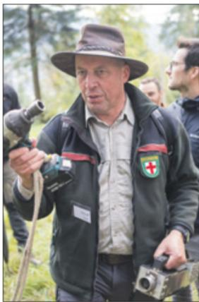
Technik für Sicherheit: Dieter Thoma, der Leiter des Roßkopfvievers, demonstriert einen neuartigen Fällkeil mit Elektroantrieb, der das Risiko bei der Arbeit am Stammfuß deutlich reduziert. (Foto: A. J. Schmidt)
