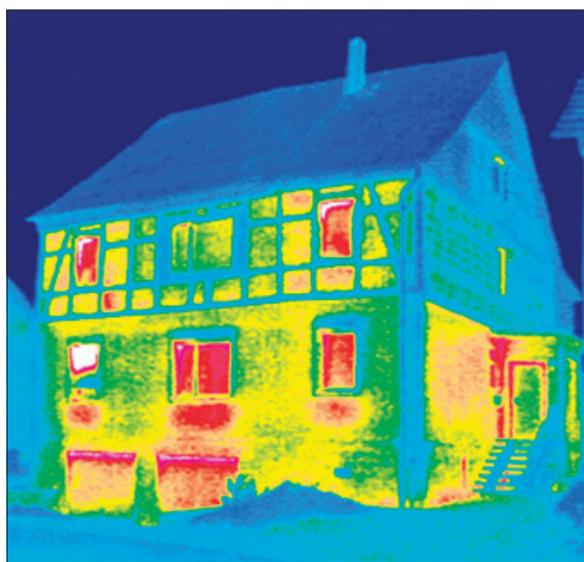
**Kältebrücken sichtbar gemacht:** Der Wärmebildkamera entgeht keine energetische Schwachstelle. Bei diesem Haus sind es die Fenster. (Foto: Fesa)
