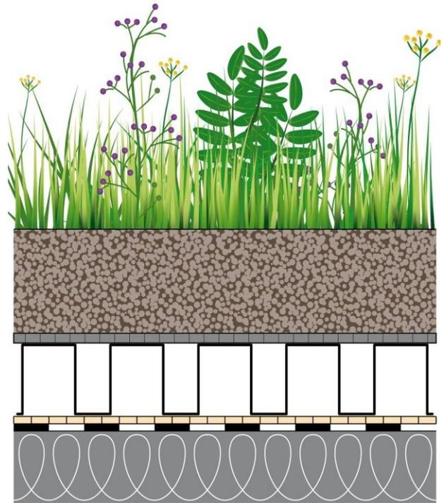
Abb. 03: Schichtenaufbau (BuGG)
