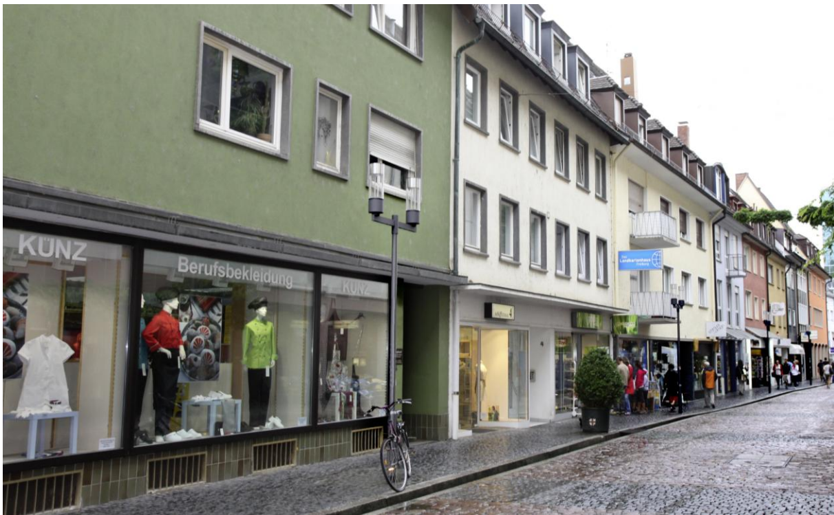
Bild: Die bisher sehr ineffizienten Kugelleuchten wurden gegen moderne Mastleuchten mit Lichtlenkung ausgetauscht.
